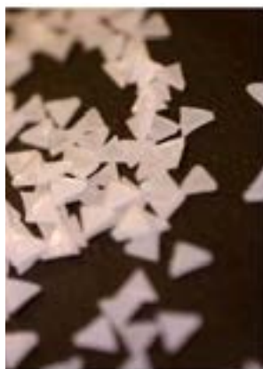
Micrografía: Grano Cerámico micro replicado
