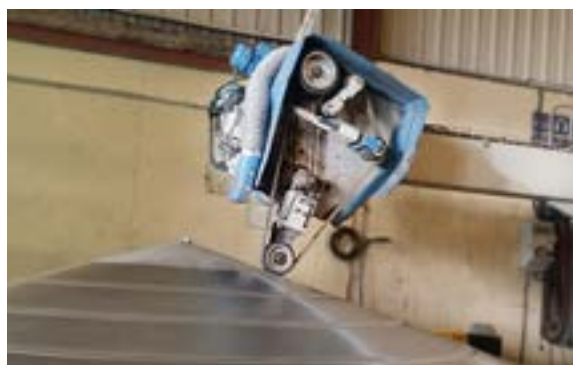
Lijado con una máquina automática con banda
